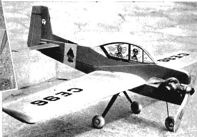
Fig. 3 - Osservate i particolari relativi alla sistemazione del motore e del relativo serbatoio per il carburante. Anche il carrello di atterraggio a tre ruote molleggiate rende facile le operazioni di decollo e atterraggio.
